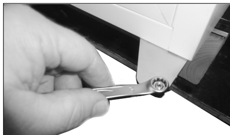
24. Monter og spænd hængseltapmøtrikken.
