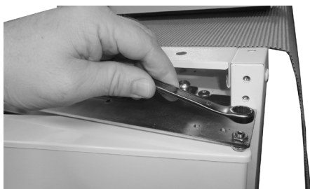
9. Loosen pivot nut (use 10 mm spanner)
