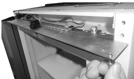
11. Den oberen Drehzapfen der Tür lösen. (mit einem 2,5 mm Inbusschlüssel, falls erforderlich)
