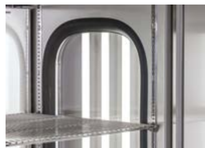
Beaucoup de lumière, mais pas trop de chaleur: Ces tubes fluorescents sont isolés thermiquement de la chambre d'essais
