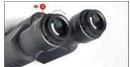
3 – Sehen Sie mit dem linken Auge durch das linke Okular. Drehen Sie das Rädchen für die Dioptrieneinstellung bis das Bild scharf sichtbar ist.
