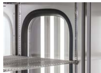
Viel Licht, aber nicht zu viel Wärme: Diese Leuchtstoffröhren sind thermisch vom Prüfraum getrennt.
