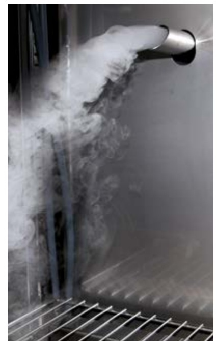
Aerosolnebel ohne Wärmeeintrag in den Prüfraum.
