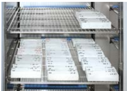
Frost-Tau-Wechseltests in der Baustoffprüfung zeigen, wie beständig das Material ist.
