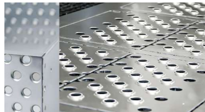
Poinçonnage de plaques métalliques
