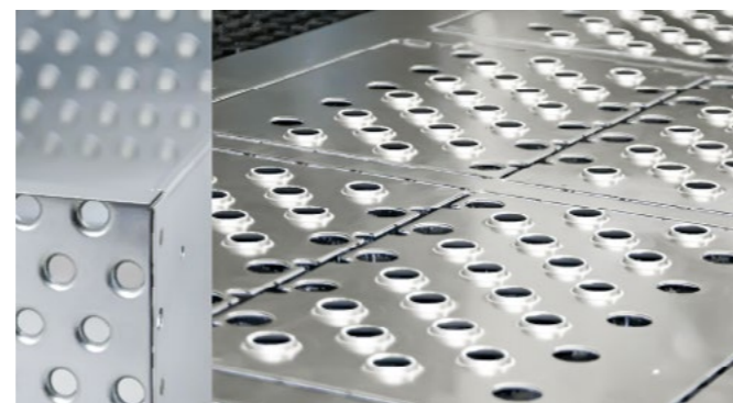
Poinçonnage de tôles
