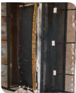
Armoire APRÈS le test de résistance au feu
