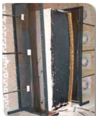
Armoire Exacta série EFO APRES le test de résistance au feu
