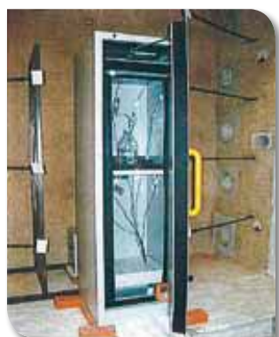
Armoire Exacta série EFO AVANT le test de résistance au feu
