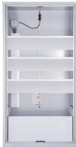
2 Notre système breveté d'inclinaison automatique des batteries. En cas d'incendie, le système fera basculer les étagères et fera ainsi glisser leur contenu dans le réservoir d'eau situé en partie basse de l'armoire.
