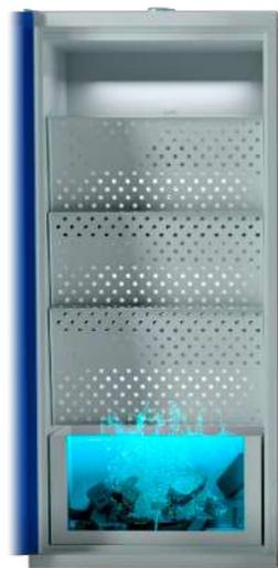
3 Les batteries tomberont dans le réservoir d'eau, les plaçant en immersion et excluant ainsi la possibilité d'une nouvelle inflammation.
