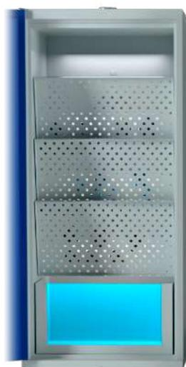
2 Notre système breveté d'inclinaison automatique des batteries. En cas d'incendie, le système fera basculer les étagères et fera ainsi glisser leur contenu dans le réservoir d'eau situé en partie basse de l'armoire.
